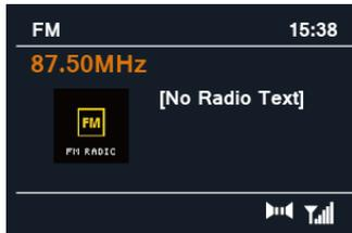
3. **Um manuell zu scannen**, während die FM-Frequenz angezeigt wird, drehen Sie den **SCROLL**-Regler im oder gegen den Uhrzeigersinn, um die Frequenz um 0,05 MHz pro Schritt zu ändern.
