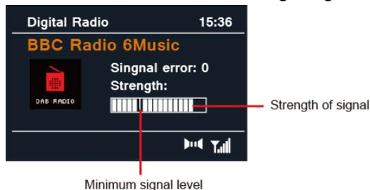
Die Anzeige auf dem Signalbalken zeigt den minimal akzeptablen Signalpegel an.
