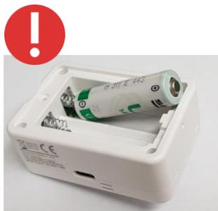
Der Sensor arbeitet mit 1 oder 2 Batterien des Typ ER14500, diese haben eine Nennspannung von 3.6 V und eine Kapazität von 2600mAh. Der Betrieb erfolgt parallel, das bedeutet, dass die Batterien in identischer Lage eingesetzt werden. **Achten Sie darauf, dass sich der Minuspol auf der Metallfeder im Batteriefach befindet, der Pluspol mit der runden, abgeflachten Spitze muss sich auf dem flachen Batteriekontakt befinden.**
