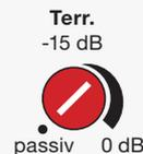
Dieser Regler ermöglicht die Absenkung des terr. Signals bzw. die Erweiterung des Rückwegs
